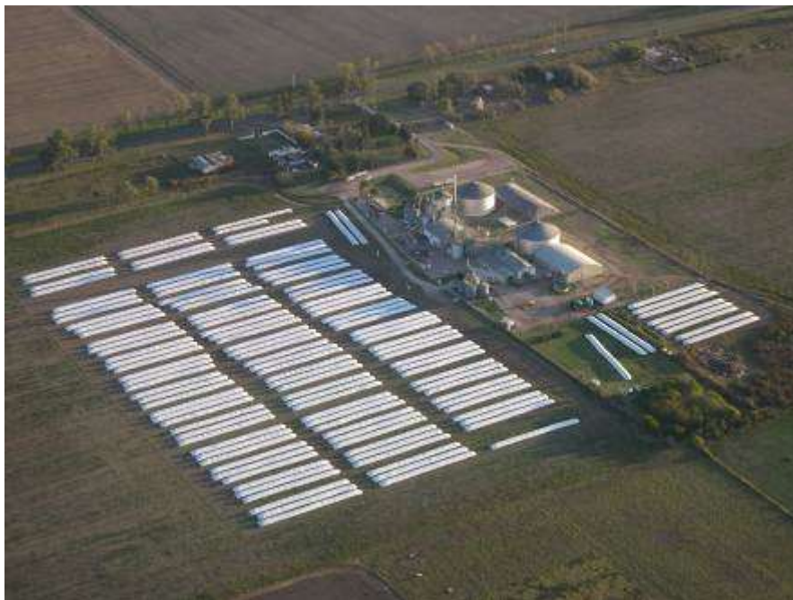
Figura 0.4. Fotografía aérea de bolsas plásticas. Nótese el correcto agrupamiento de las bolsas en grupos de 2 o 3 unidades; esta configuración permite la rápida extracción de cualquier bolsa en caso de detectarse deterioros de calidad del grano.
