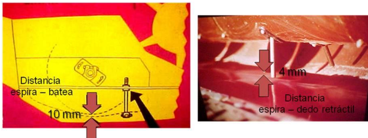
Figura 9. Regulación de espira y dedo retráctil de sinfín.
