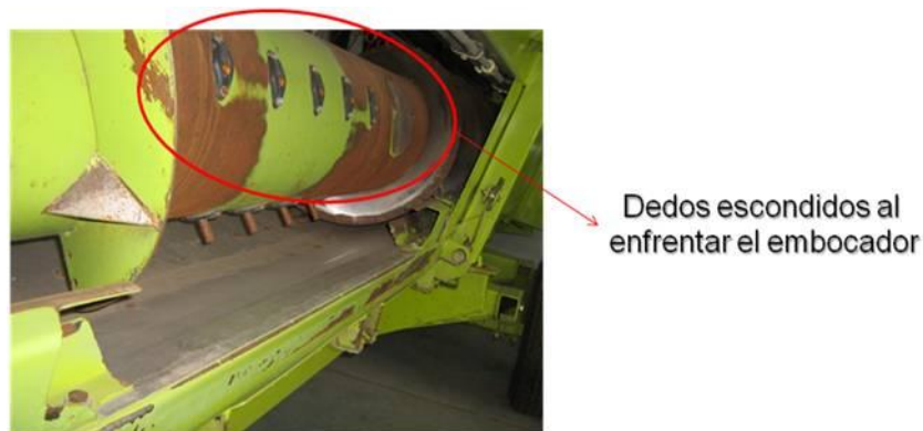
Figura 8. Regulación correcta de los dedos retráctiles centrales, escondidos al enfrentar el embocador.
