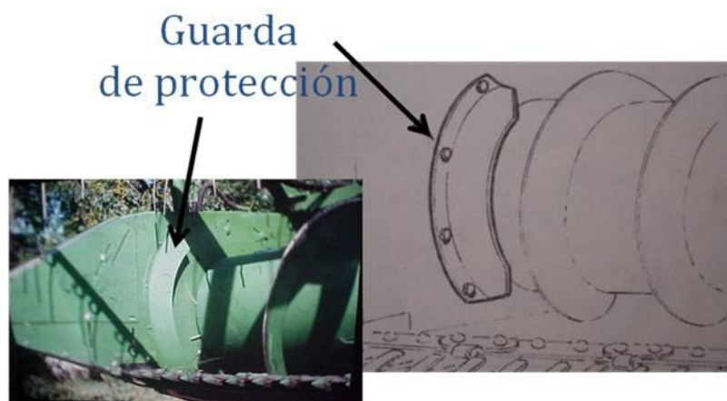
Figura 11. Guarda deflectora para la protección de los rodamientos del sinfín.
