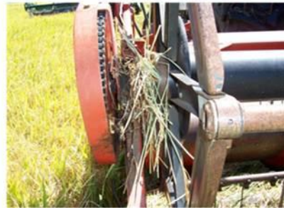
Figura 6. Puntón lateral descubierto. Enganche de plantas y panojas.
