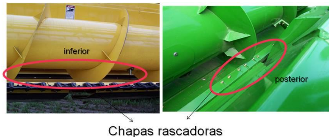
Figura 10. Chapa rascadora inferior y posterior, fragmentada y con registro de regulación.
