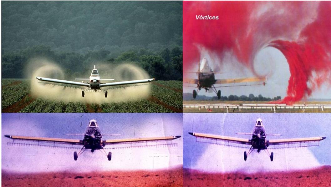
**Figura 2: Efecto de vórtice: a) arriba visualización, b) abajo corrección**
