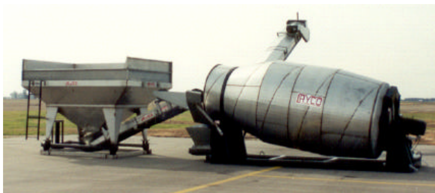
Figura 2 Equipo mezclador de eje inclinado con tolva con balanza. Imagen gentileza de Anne Yargus Sheehy (Yargus Manufacturing Inc.).
