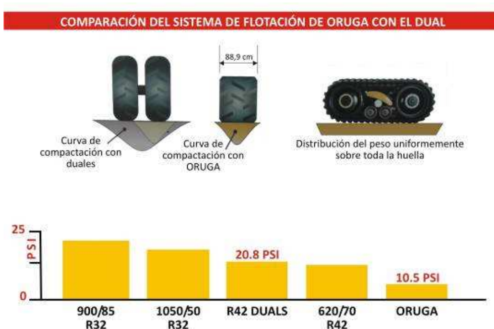
Figura 22: Cuadro comparativo del sistema por orugas de caucho, respecto a los otros sistemas de traslado de cosechadoras. Fuente: Claas Estados Unidos. Farm Progress Show 2011.
