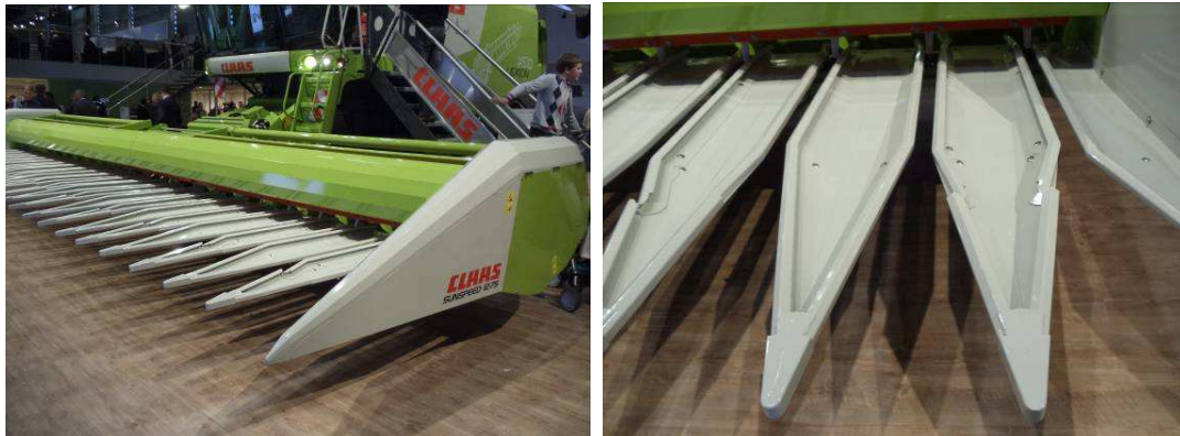
Figura 11: Cabezal de última generación con bandejas con extremos agudos y bordes redondeados.
