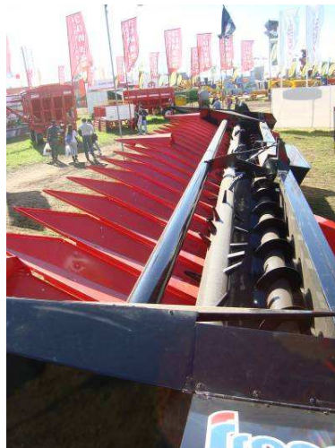
Figura 13: Cabezal girasolero con sistema de tambor giratorio.
