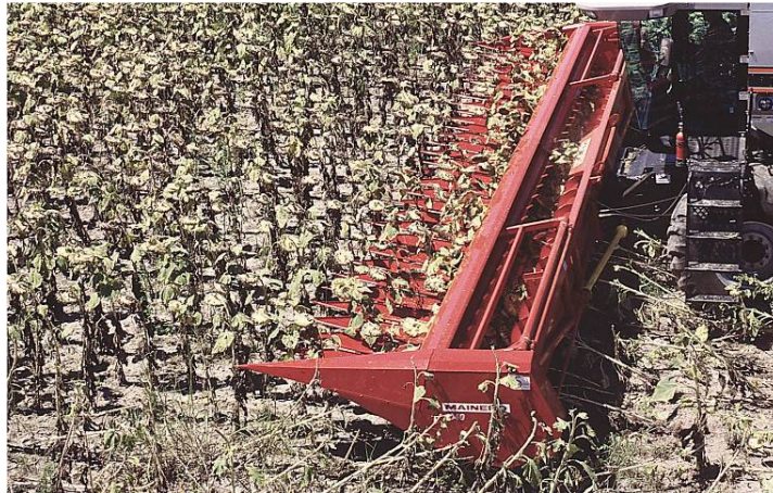
Figura 4. Vista de un cabezal girasolero trabajando. La función es separar los capítulos de la planta, con la menor cantidad de tallos posibles.
