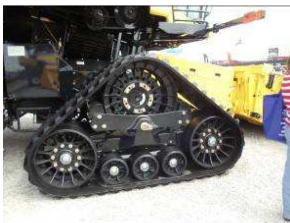
Figuras 23: Cosechadoras con orugas de caucho de buena prestación para disminuir la compactación y el huellado característico que producen los neumáticos tradicionales.
