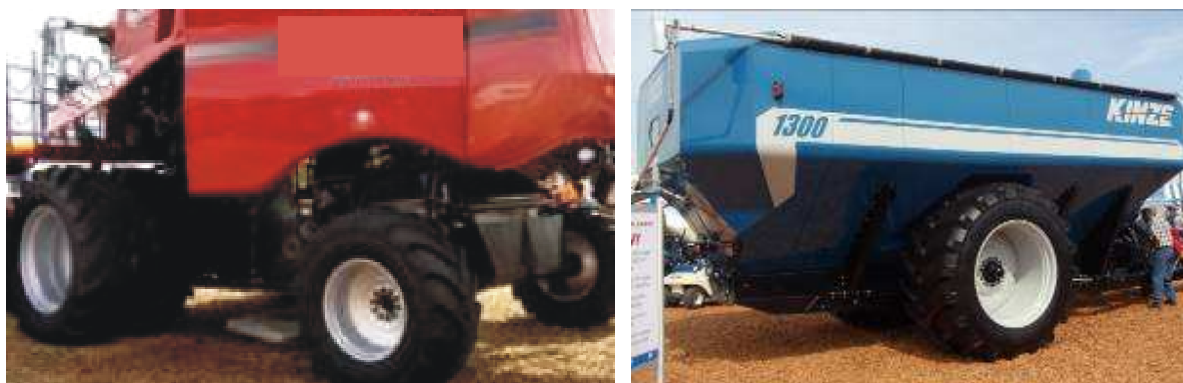
Figuras 21: Cosechadoras y tolvas equipadas con neumáticos radiales de alta flotabilidad y buen ancho.
