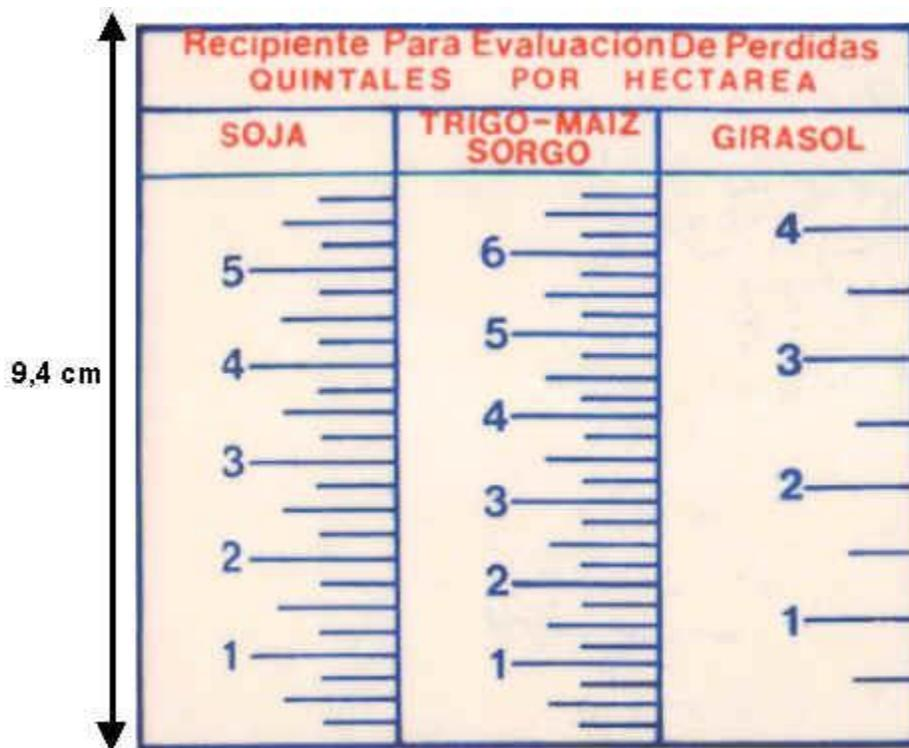
Figura de la graduación que lleva el recipiente que mide 9,4 cm de altura y 3,9 cm de diámetro interno.
