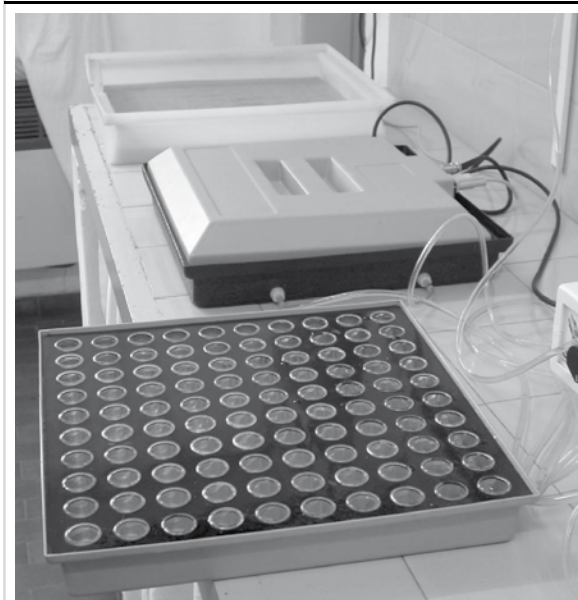
Foto 2: Equipo SAD 9000-S para medición de la Conductividad Eléctrica de semillas individuales.
