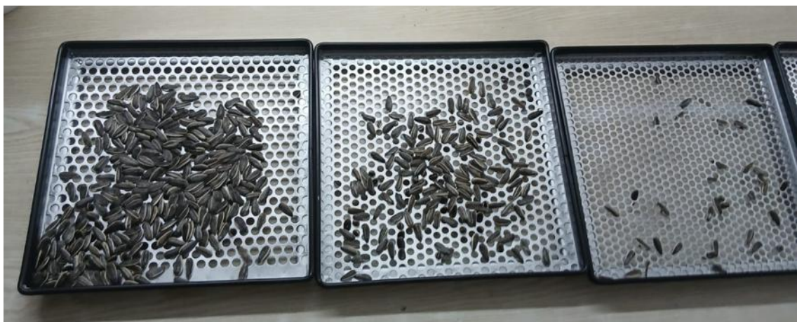
Figura 2. Medición de calidad de girasol confitero en base a retención diferencial en zarandas.
