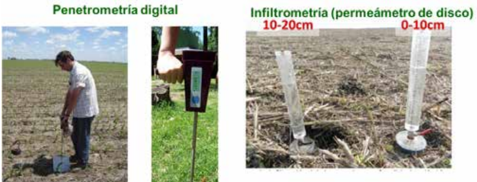
Figura 1. Medición de la resistencia a la penetración a campo mediante un penetrómetro digital (izquierda) y uso de infiltrómetros de disco de succión para medición de infiltración (derecha).
