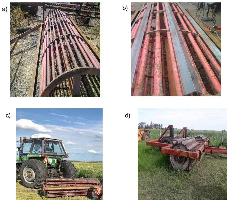
**Figuras 2.** Rolos utilizados durante la experiencia. a) Rolo desterronador original, b) y c) Rolo desterronador modificado para el rolado de coberturas, d) Rolo triturador de rastreo.
