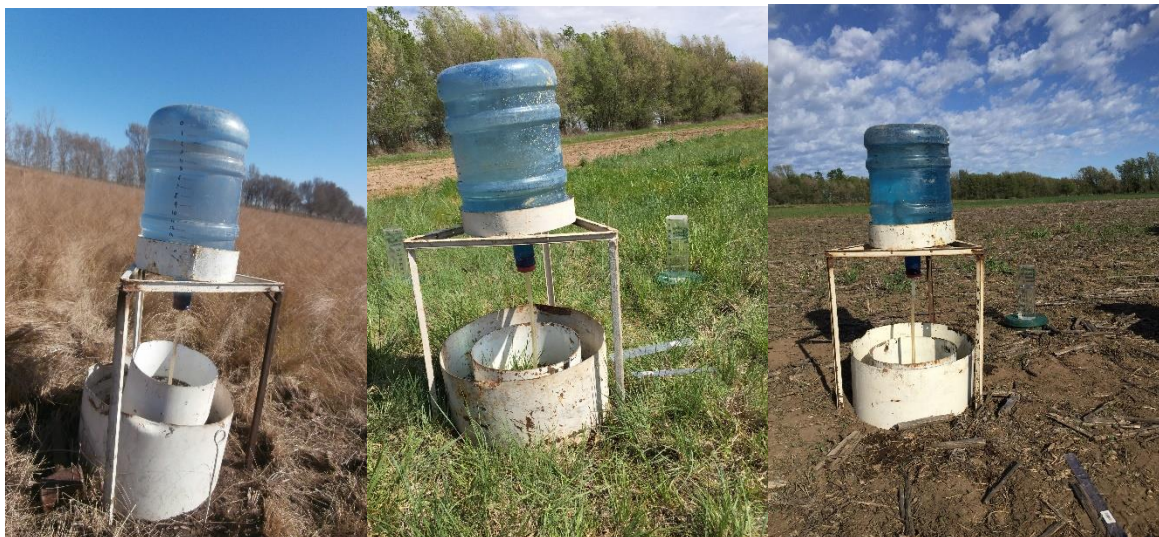
Imágen que refleja la metodología de infiltración a campo en suelo bajo llorón, pastura y agrícola.
