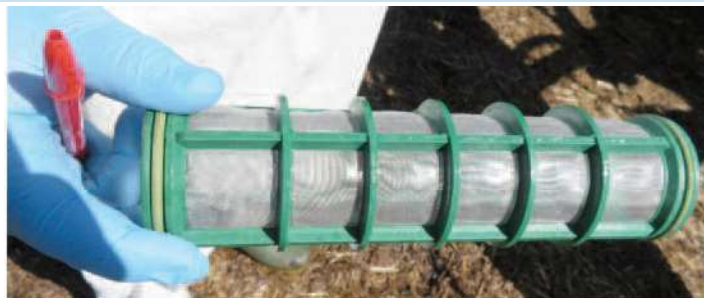
Foto 1 | Filtro de línea en correcto estado
