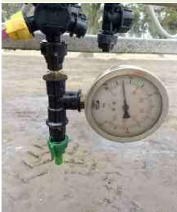
Figura 10 | Manómetro de prueba de presión en la barra de pulverización.
