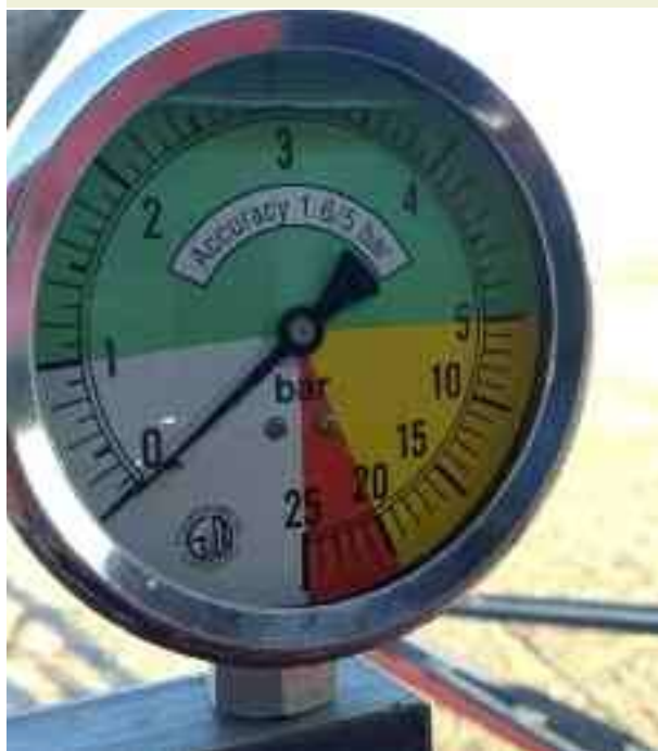
Figura 9 | Manómetro con diámetro, escala y resolución aceptables.
