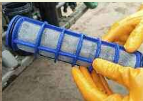
Figura 8 | Filtro de línea en buen estado
