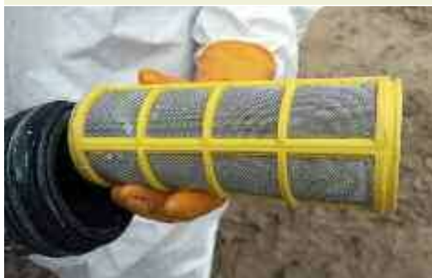
Figura 7 | Portafiltro en buen estado que permite fácil desarme y extracción del filtro.
