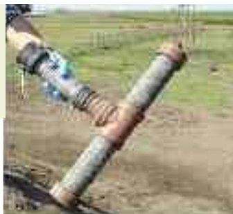
Figura 6 | Incorporador en buen estado, con rejilla, sistema de mezclado y limpieza de envases.
