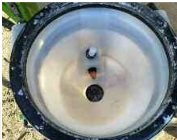
Figura 6 | Incorporador en buen estado, con rejilla, sistema de mezclado y limpieza de envases.
