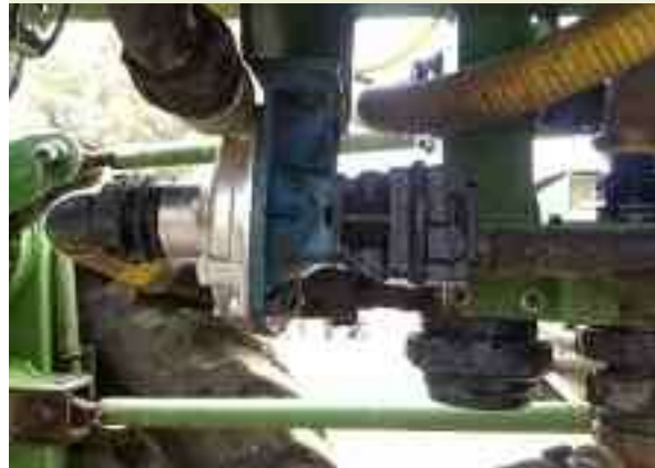
Figura 4 | Bomba de pulverización sin fugas visibles.
