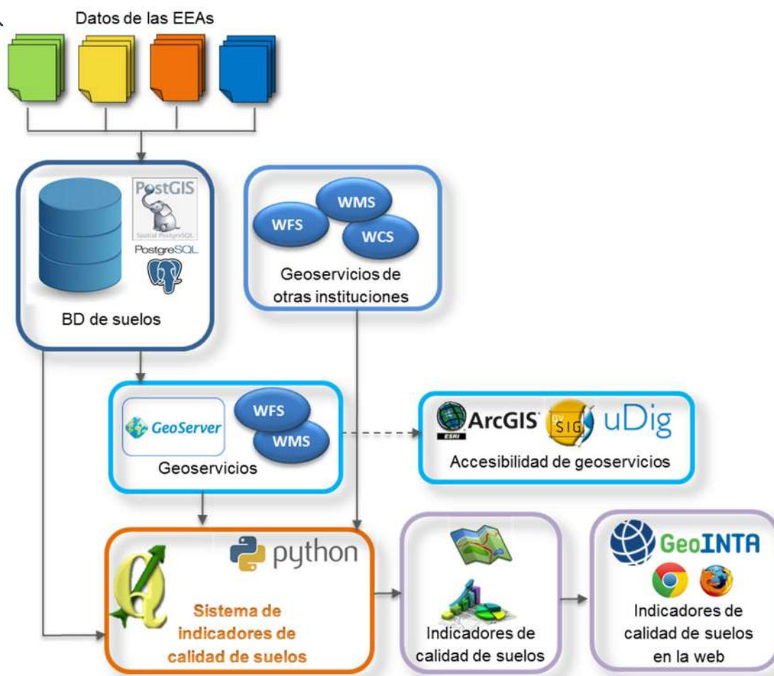
Figura 3. Diseño de la arquitectura y tecnologías del Sistema de indicadores de calidad de suelos
