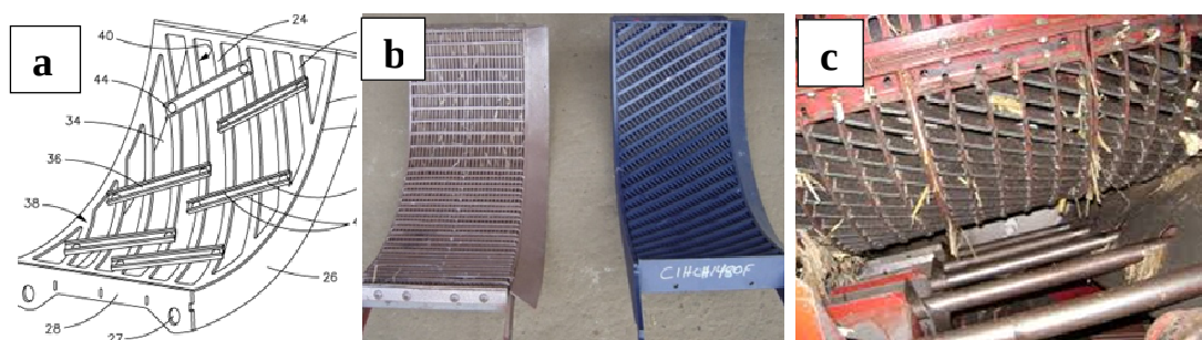
Figura 1. – a Esquema detallado del primer cóncavo de trilla con barras oblicuas patentado por CNH. – b Dos diseños de cóncavos para granos finos americanos actuales: tradicional a la izquierda y de barras oblicuas a la derecha, para cosechadoras CASE IH. – c Juego de tres cóncavos oblicuos de trilla para granos gruesos (misma marca).
