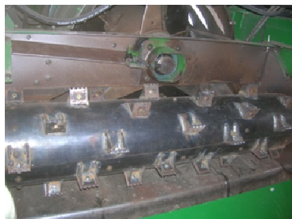
Figura 7. Vista general del rolo acelerador transversal experimental, con disposición helicoidal de sus pletinas, que alimenta al rotor de trilla y separación axial.
